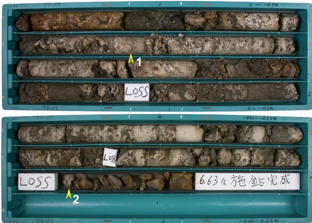
圖 6. 桃園觀音潮音海岸潮間帶鑽探岩心(鑽孔編號 TY-07)，礁體厚度 6.2 公尺。岩心箱左側為地層上方，每格放置岩心長度 1 公尺，右側數字標示為向下鑽探深度；黃箭頭 1 以上為有珊瑚生長的藻礁石灰岩；黃箭頭 1-2 區間為有珊瑚藻生長的珊瑚礁石灰岩；箭頭 2 以下為礫岩，是礁體的發育基底。
