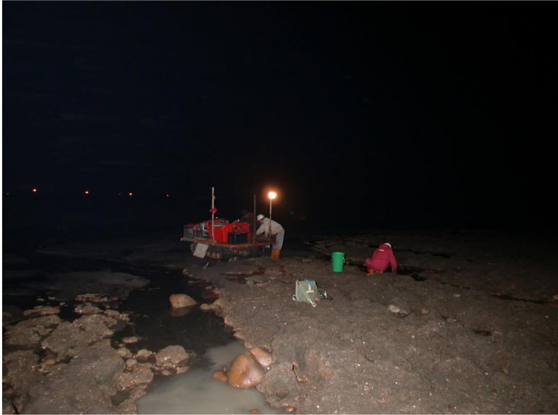
圖 4. 桃園觀音觀音溪出海口南側潮間帶，夜間藻礁鑽探作業。
